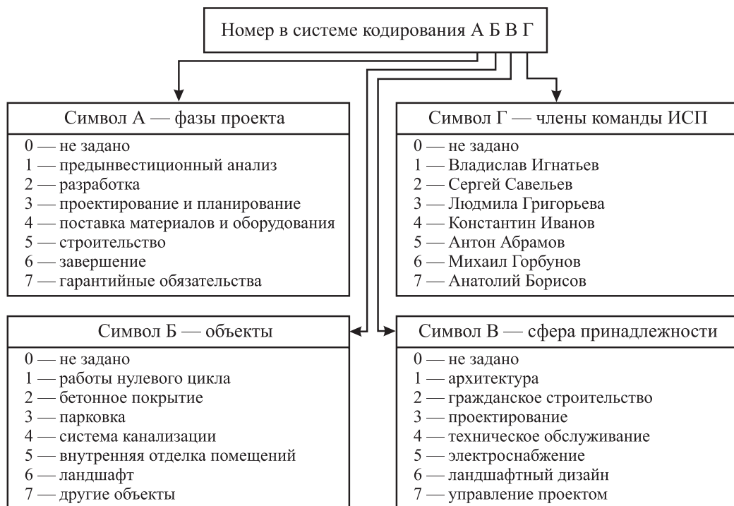
Рис. 7.6. Пример простой четырехзначной системы кодирования ИСП
