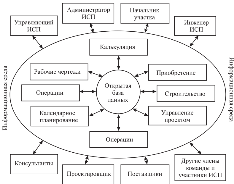
Рис. 10.3. Модель системы комплексно-автоматизированного строительства для ИСП
